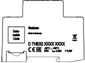
① Die Leistungsangaben befinden sich auf der Seitenfläche und der Geräteschulter (siehe Bild) und sind nach der Installation nicht mehr sichtbar!
