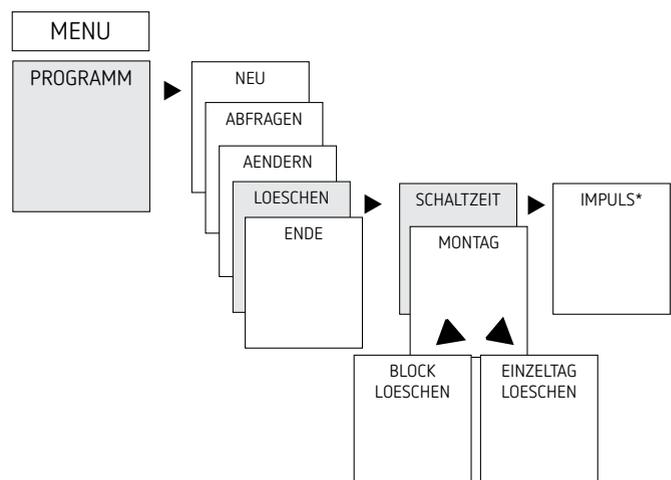
① Sie können entweder einen Block löschen d. h. eine Schaltzeit, die auf mehrere Tage (z. B. Mo–Fr) kopiert ist, oder eine einzelne Schaltzeit
