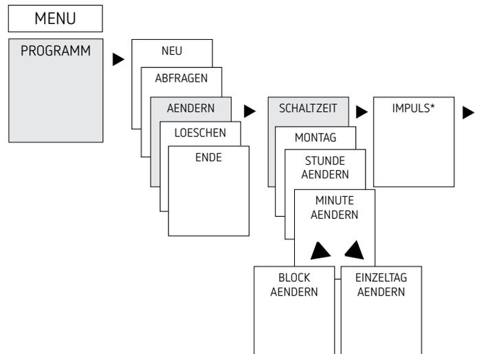
① Sie können entweder einen Block ändern, d. h. eine Schaltzeit, die auf mehrere Tage (z. B. Mo–Fr) kopiert ist, oder eine einzelne Schaltzeit
