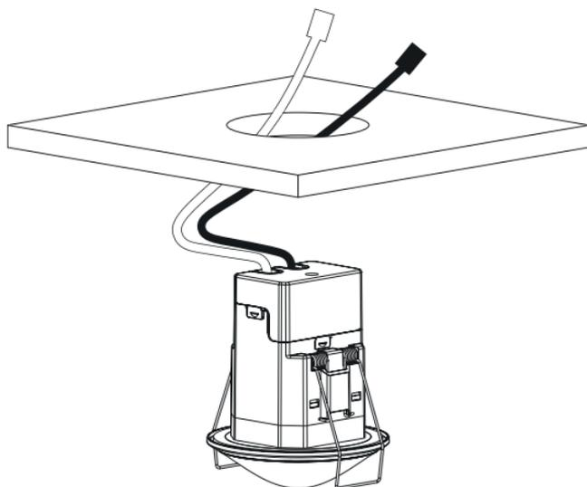
Einbau in Hohldecken für Deckenstärken von 0,5 mm bis 3 cm. Der Durchmesser des Deckenausschnitts muss zwischen 62 mm und 70 mm betragen.
