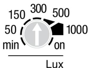
Mit der Management-Fernbedienung können Helligkeits-Schaltwerte von 5 bis 3000 Lux eingestellt werden. Gemäss der Norm EN 12464 werden folgende Einstellungen empfohlen:
