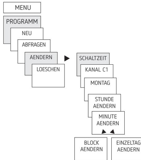
① Sie können entweder einen Block ändern, d. h. eine Schaltzeit, die auf mehrere Tage (z. B. Mo–Fr) kopiert ist, oder eine einzelne Schaltzeit
