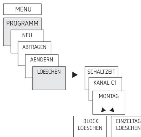
① Sie können entweder einen Block löschen d. h. eine Schaltzeit, die auf mehrere Tage (z. B. Mo–Fr) kopiert ist, oder eine einzelne Schaltzeit
