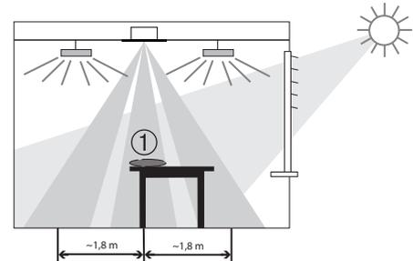
$$\text{Raum-Korrekturfaktor} = \frac{\text{Helligkeitswert an der Decke}}{\text{Helligkeitswert auf der Arbeitsfläche}}$$
