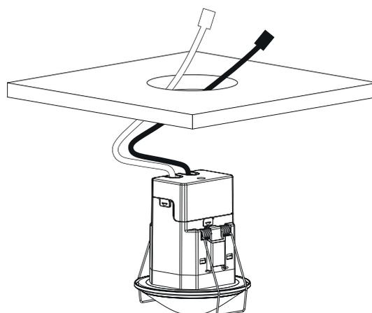
Einbau in Hohldecken für Deckenstärken von 0.5 mm bis 3 cm. Der Durchmesser des Deckenausschnitts muss zwischen 62 mm und 70 mm betragen.
