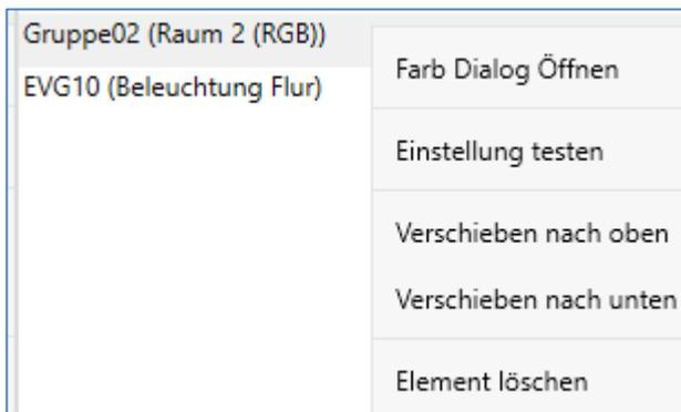
Dazu wird eine Verbindung zum DALI-Gateway KNX plus benötigt. Der Befehl mit der Einstellung des Wertes und der Farbe wird für diese Gruppe oder EVG ausgeführt. So kann die gewünschte Eigenschaft vor dem Programmieren des gesamten Effektes kontrolliert werden. Falls die Eigenschaften "Wert beibehalten" oder „Farbe beibehalten“ gesetzt sind, werden die entsprechenden Werte nicht aktiviert, sondern auf dem aktuellen Wert beibehalten.
