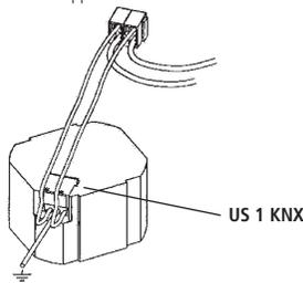
Bild 2: Anschluß des **US 1 KNX** an der vorhandenen Busklemme des Busankopplers
