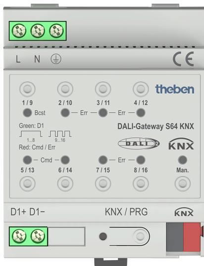
Die Tasten und LEDs sind auch ohne Entfernen der Abdeckung in der Verteilung zugänglich. Im KNX-Busbetrieb und bei fehlerfreiem Gateway sind alle 9 LEDs aus. Erkennt das Gateway einen Fehler (z. B. einen Lampenfehler oder KNX-Fehler), blinkt nur die LED in der Man. Taste schnell (rot). Läuft im Gerät ein Programmiervorgang (z. B. während einer Neu- oder Nachinstallation) blinken alle LEDs (bis auf Man.) des Gerätes langsam (rot).
