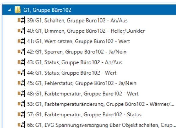
Nach der Planung, Einstellung der Parameter und Verknüpfung der Gruppenadressen erfolgt die eigentliche Inbetriebnahme des DALI-Segments. Zu diesem Zweck ist es erforderlich, den Inbetriebnahme-PC mit der ETS über eine Schnittstelle (RS-232, USB oder IP) mit dem KNX-System wie gewohnt zu verbinden.
