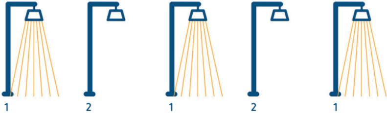
3. Wöchentlich/täglich den abgeschalteten Kanal wechseln, um die Verbraucher gleichmäßig abzunutzen.
