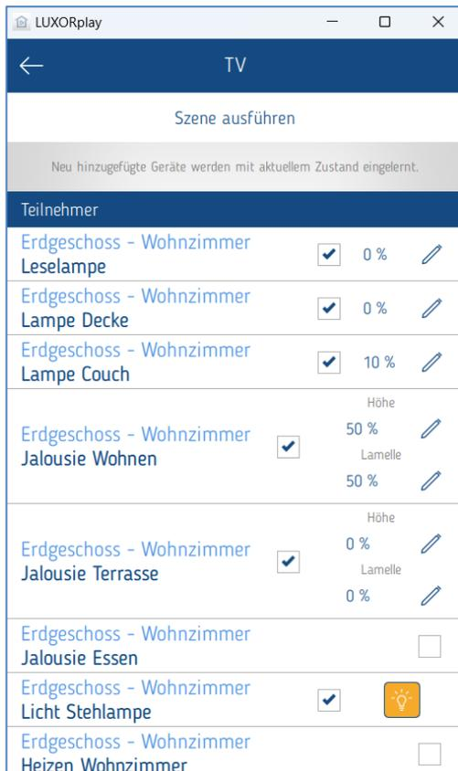
Die Zuordnung der Teilnehmer wird durch Anklicken des Kontrollkästchens aktiviert. Der aktuelle Zustand wird sofort in LUXORplay angezeigt (aktueller Dimmwert, aktuelle Position (Höhe/Lamelle), Schaltstatus).
