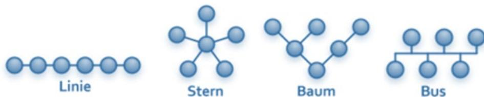
Eine Verbindung als geschlossener Ring oder vermascht ist nicht zulässig und führt zu Funktionsproblemen bei der Programmierung und Kommunikation!
