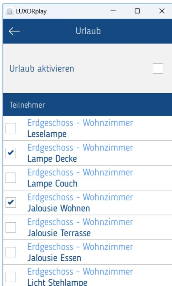
Die Parametrierung der Anwesenheitssimulation für eine bestimmte Funktion erfolgt durch einen Klick in die Funktion.
